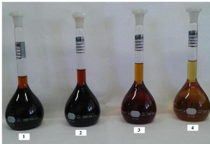
Figura 6 - Soluções das amostras dos catalisadores: (1) Ru/Al<sub>2</sub>O<sub>3</sub> (lote 1), (2) Ru/Al<sub>2</sub>O<sub>3</sub> (lote 2), (3) Ir- Ru/Al<sub>2</sub>O<sub>3</sub> e (4) Ir/Al<sub>2</sub>O<sub>3</sub>
