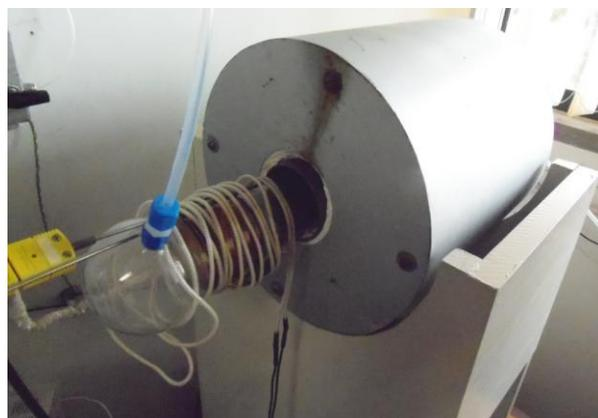
Figura 2 – Forno para tratamento térmico
